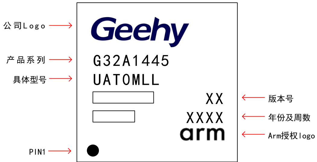
图 9 LQFP100 – 100 引脚，14 x 14mm 示意图
