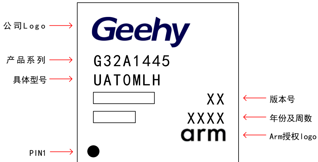
图 12 LQFP64 – 64 引脚，10 x 10mm 示意图
